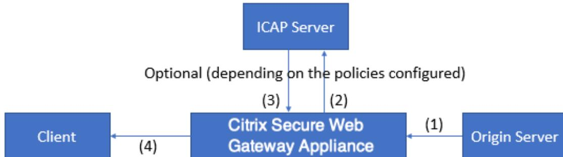
(1) Der Ursprungsserver reagiert auf die Citrix SWG-Appliance. (2) Die Appliance leitet die Antwort auf den ICAP-Server weiter, basierend auf den auf der Appliance konfigurierten Richtlinien. (3) Der ICAP-Server antwortet mit der Meldung “Keine Anpassung erforderlich”, Fehler oder geänderte Anforderung. (4) Abhängig von der -Antwort vom ICAP-Server, leitet die Appliance entweder den angeforderten Inhalt an den Client weiter oder sendet eine entsprechende Nachricht.
