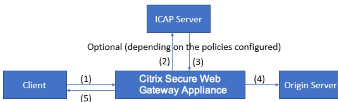
(1) Die Citrix SWG-Appliance fängt Anforderungen vom Client ab. (2) Die Appliance leitet diese Anforderungen basierend auf den auf der Appliance konfigurierten Richtlinien an den ICAP-Server weiter. (3) Der ICAP-Server antwortet mit der Meldung "Keine Anpassung erforderlich", Fehler oder geänderte Anforderung. Die Appliance leitet entweder (4) den Inhalt an den vom Client angeforderten
