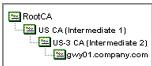
Figura 2. Una cadena de certificados digitales típica
