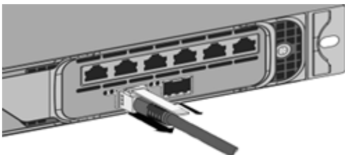
Figura 9. Extraer un DAC del puerto 10G
