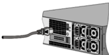
Ilustración 10. Insertar un cable de alimentación
