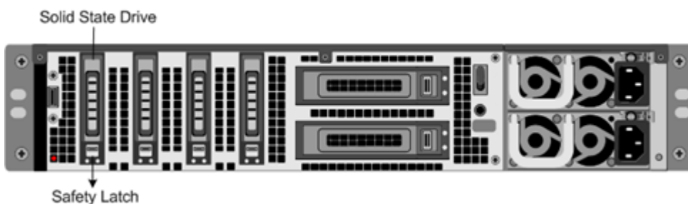
Figura 4. Quitar la unidad de estado sólido existente
