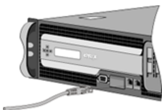
Figura 8. Insertar un cable Ethernet
