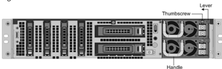
Figura 2. Retire la fuente de alimentación de CC existente
