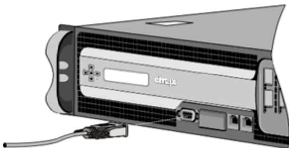
Figura 9. Insertar un cable de consola
