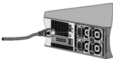
Figura 9. Inserción de un cable de alimentación
