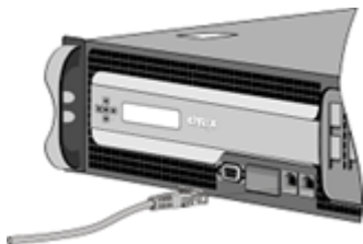
Figura 7. Inserción de un cable Ethernet
