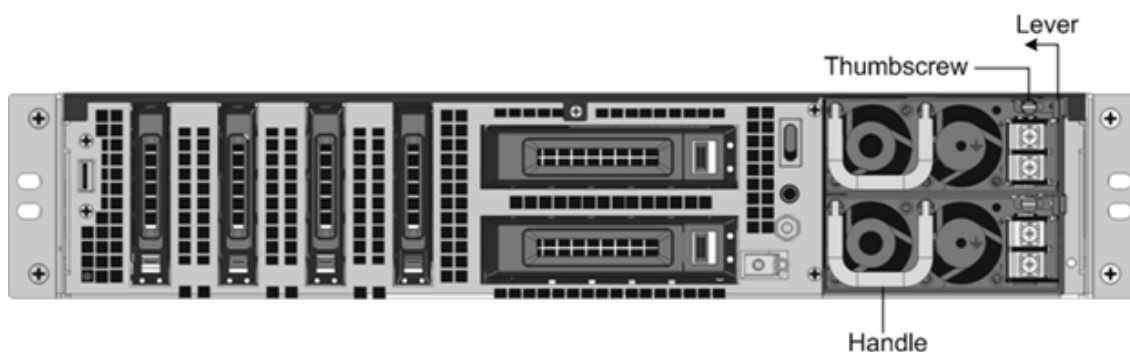
Figura 2. Eliminar una fuente de alimentación de corriente continua existente
