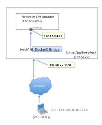
Dans cet exemple, l'adresse IP de l'hôte Docker est 192.68.x.x et l'adresse IP unique de l'instance NetScaler CPX est 172.17.0.4. Le port SSH 22 de l'instance NetScaler CPX est mappé au port 1100 sur l'hôte Docker. La demande SSH du client est reçue sur l'adresse IP 192.68.x.x sur le port 1100. L'hôte Docker effectue une traduction d'adresse de port pour mapper cette adresse et ce port à l'adresse IP unique 172.17.0.4 sur le port 22 et transmet la demande du client.
