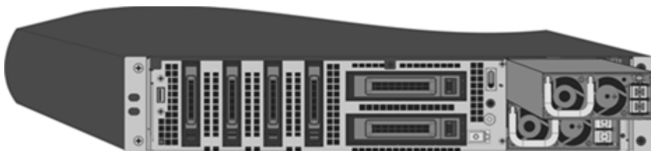
Figure 3. Insertion du bloc d'alimentation CC de remplacement
