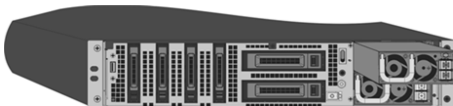
図 3: 交換用 DC 電源装置の挿入
