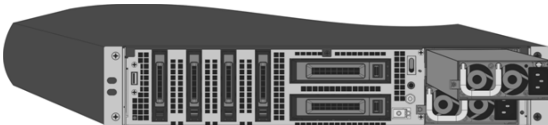
図 4. 交換用 DC 電源装置を挿入します
