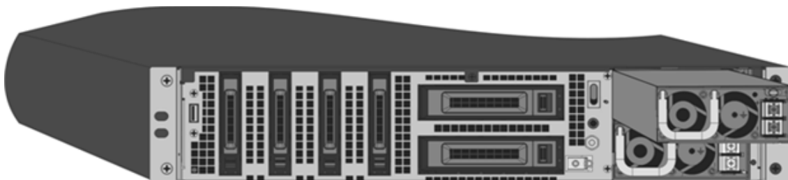
図 4. 交換用 DC 電源装置を挿入します
