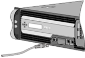
図 7: Ethernet ケーブルの挿入
