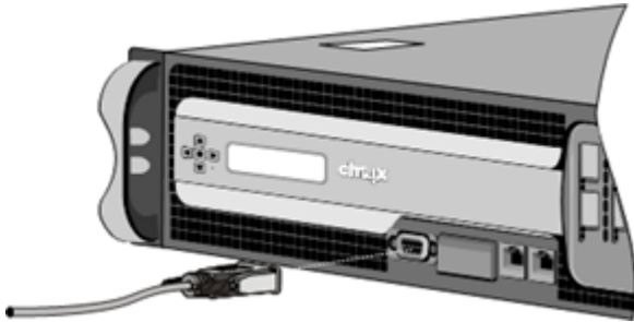
图 8. 插入控制台电缆
