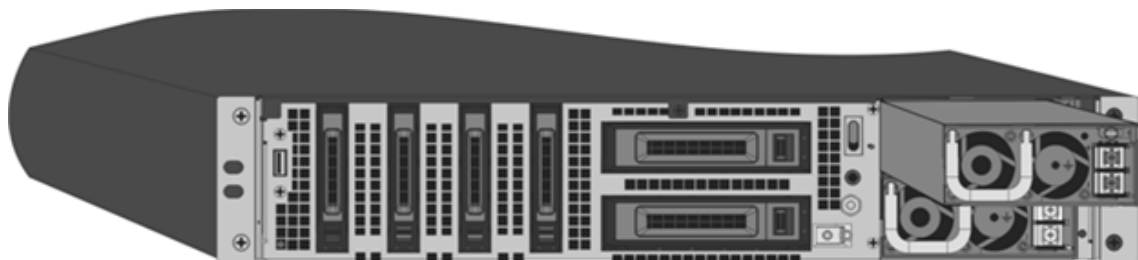
图 4. 插入替换直流电源
